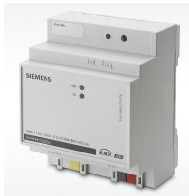
Das Gerät dient als Schnittstelle zwischen KNX und BACnet. Dabei werden die parametrisierten KNX Kommunikationsobjekte als BACnet Objekte übersetzt und können somit in die BACnet-Welt kommunizieren. BACnet Clients können sich entweder über eine sogenannte COV-Subscription anmelden und werden automatisch über KNX Ereignisse informiert, oder aber sie verwenden den Read Property-Service, um nach Bedarf den Zustand der Objekte abzufragen.
